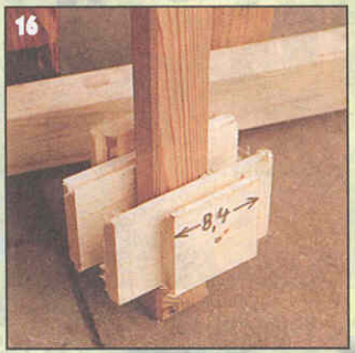
16 В качестве шаблона можно использовать обычную рейку, прибив к ней сверху и снизу отрезки досок.
